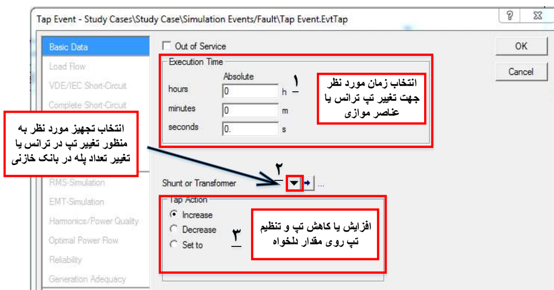
شکل (۵-۲۲): رخداد تغییر تپ ترانسفورماتور
