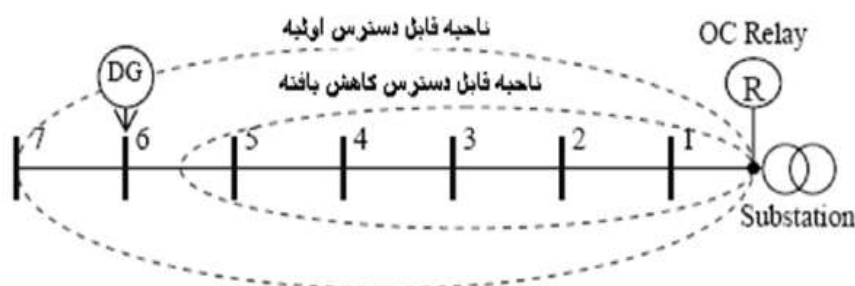
شکل (۷-۲): کاهش ناحیه قابل دسترس رله بالادست در حضور مولد DG
